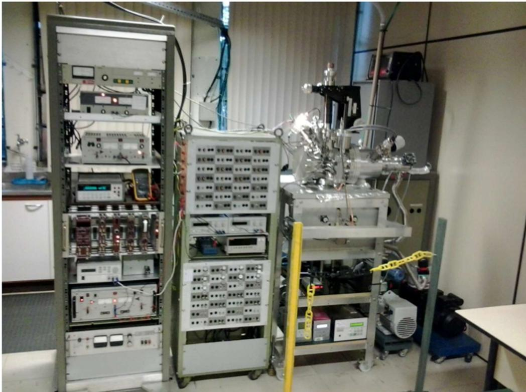
Figura 7 - Vista lateral do aparelho de medidas de Seção de Choque Totais do espalhamento de elétrons de baixas energias do LEAM.
