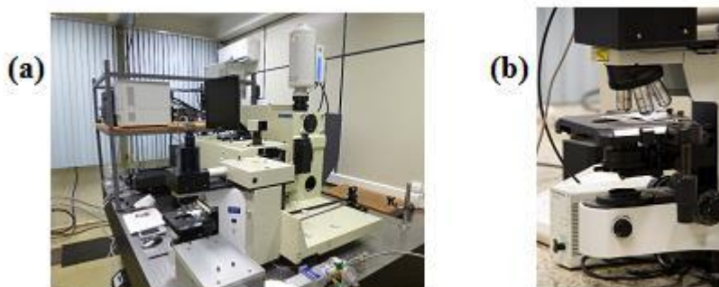
Figura 24 – Plataforma para obtenção dos espectros de Raman. (a) Equipamento Raman T64000 da Horiba Jobin Yvon e (b) microscópio confocal Olympus modelo BX41
