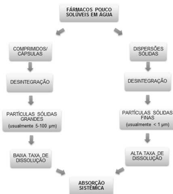
Figura 7 - Representação esquemática do aumento da biodisponibilidade e de fármacos pouco hidrossolúveis através de DS
