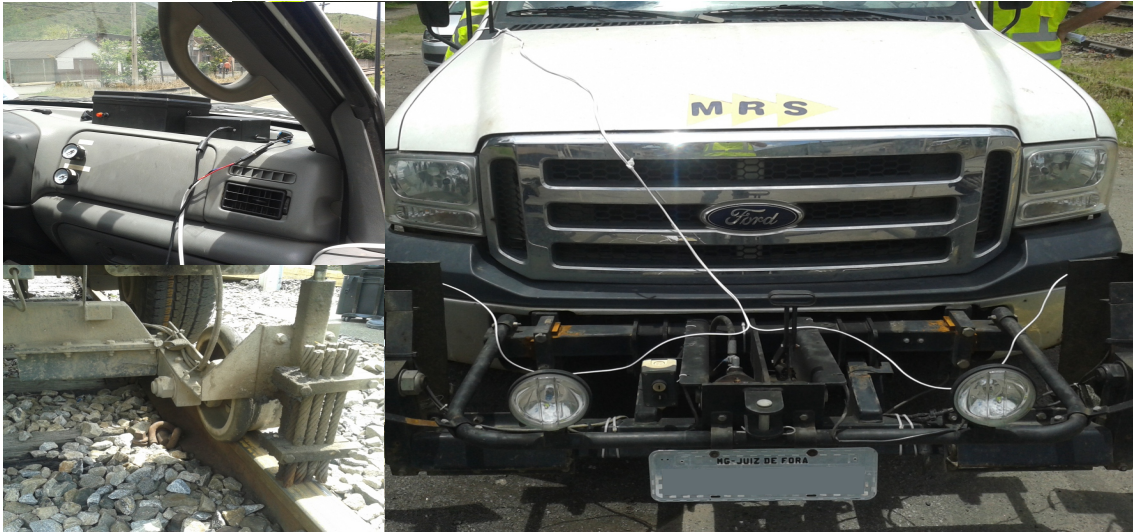
Figura 5.4: Sistema de monitoramento preventivo instalado no rodoferroviário.
