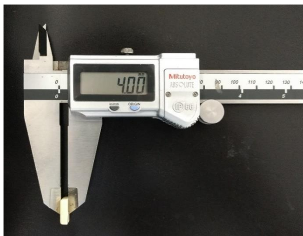
Figura 05. – Dimensões das pastilhas sem arredondamento.
