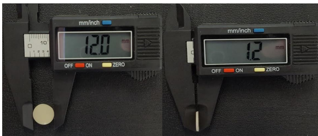
Figura 04. – Dimensões das pastilhas arredondadas.
