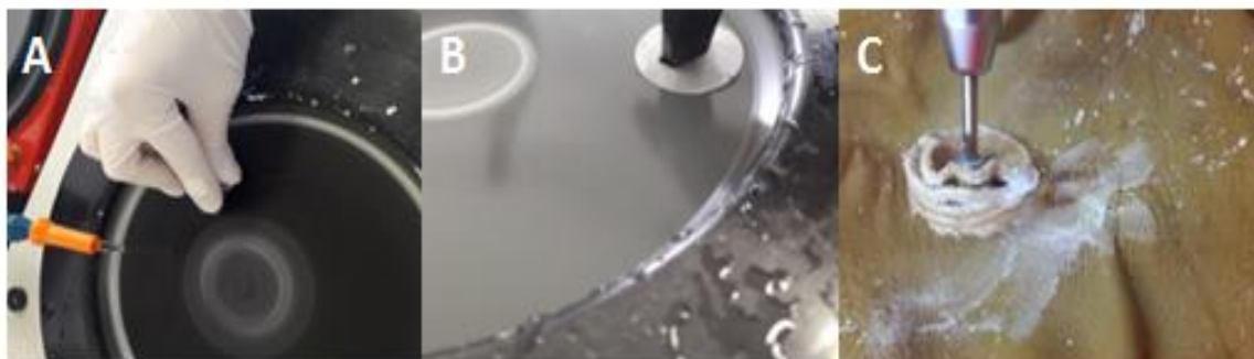
Figura 11- Processo de polimento das lâminas, utilizando lixa de gramatura 80 (A), acabamento com lixa de gramatura 600 (B) e finalização com pasta de polimento contendo óxido de alumínio (C).
