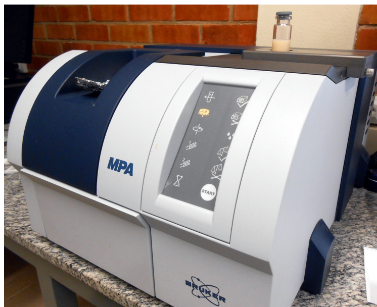
Figura 16 – Analisador Multi Propósito FT-NIR usado para obtenção dos espectros.
