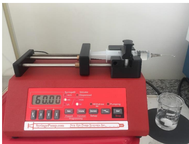
Figura 1 - Adição da solução de TPP à solução de quitosana, sob gotejamento constante 60 mL/h por meio da bomba de injeção.
