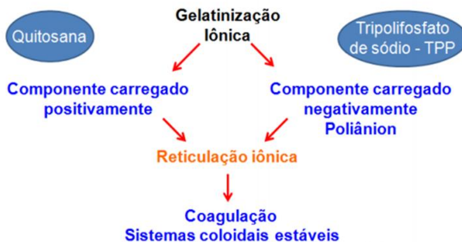
Figura 12: Processo geral de gelificação iônica. Fonte: LIMA, 2013
